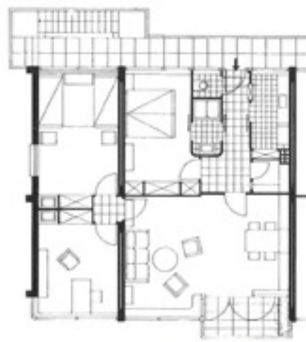
Pianta dell'alloggio di testata
