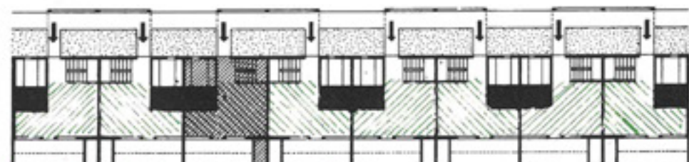
Caratteristiche organizzative degli elementi abitabili e schema del sistema associativo e distributivo delle abitazioni
